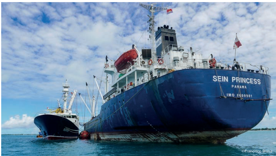
Transbordo ancorado na zona portuária. Note-se a grande defesa “Yokohama” colocada entre o navio transportador e o navio que descarrega.
