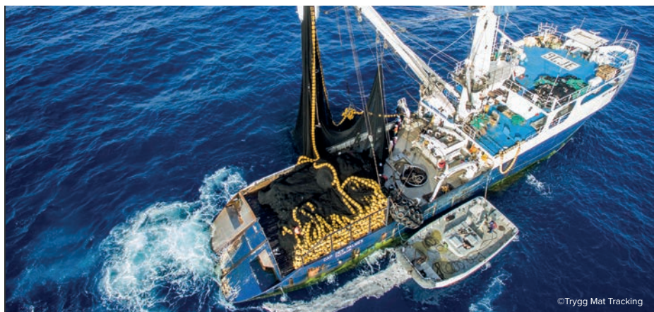
Um cercador no processo de puxar a rede depois de esta ter sido “fechada” à volta de um cardume de atum.
