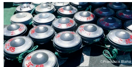
Transmissores para DCPs/FADs. Cada um deles será ligado a um DCP/FAD e transmitirá informações sobre os peixes que se encontram sob o DCP/FAD, bem como a sua localização.
