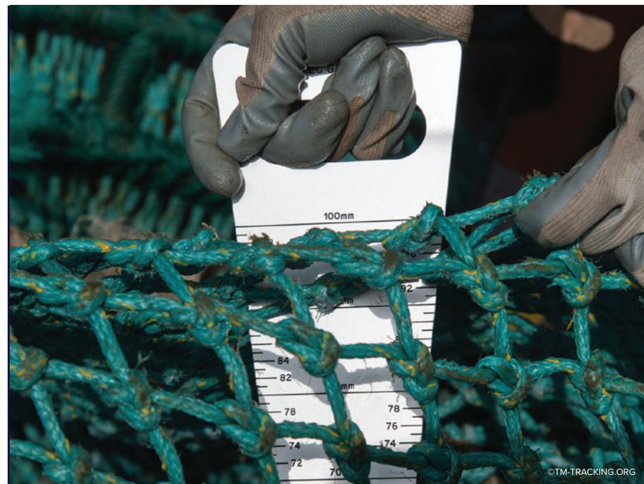
A malhagem pode ser medida usando uma ferramenta especializada chamada bitola
