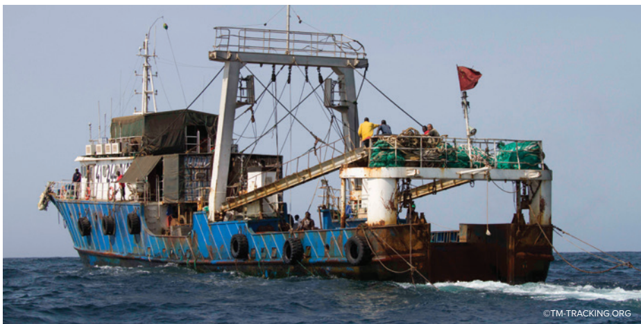
Arrastão com os cabos na água, indicando que está em operação de pesca
